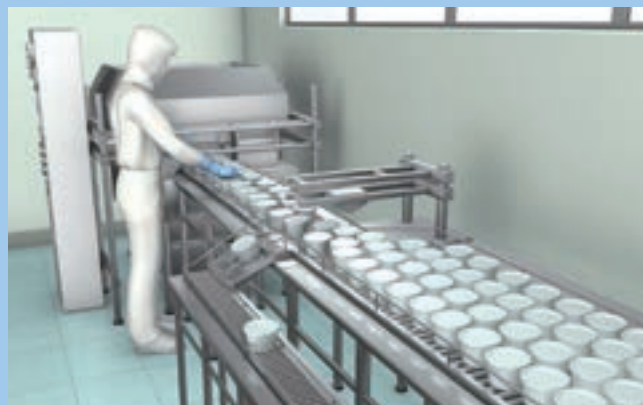
食品搬送装置/包装機など エア搬送や吸引などで消費します。
